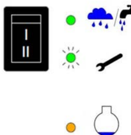
Maintenance mode „Mains water mode“
